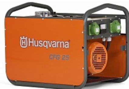
Подбор правильного вибратора осуществляется по принципу суммарного потребляемого тока вибраторами, он не должен превышать вырабатываемый преобразователем выходной ток. К примеру: CF25 вырабатывает ток в 25 А, следовательно он может питать два вибратора AX48, каждому из которых требуется 10А.
