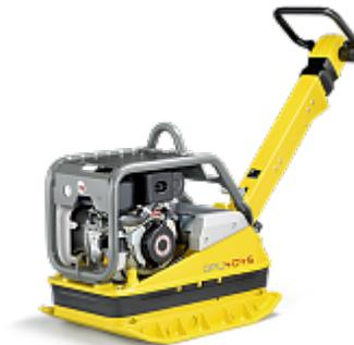
Оптимальными областями применения являются уплотнение теплоизоляционных покрытий и нижних слоев при строительстве улиц, дорожек и стоянок, а также обратной засыпке в зданиях. Благодаря частоте 69 Гц виброплита DPU4045 находит универсальное применение и осуществляет ровное и надежное уплотнение плотно прилегающей брусчатки среднего веса.
